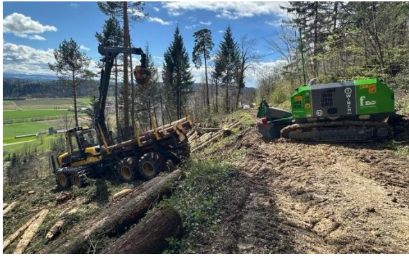
(Bild: Nicht der steilste Hang im Seeland... Der Forwarder wird von der T-Winch unterstützt)
